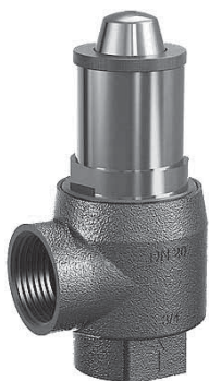
Typ MSV-HN TÜV Bauteilprüf-Nr. 516 Ganzmetall Größe 1/2 Zoll Ansprechdruck 3 bar
